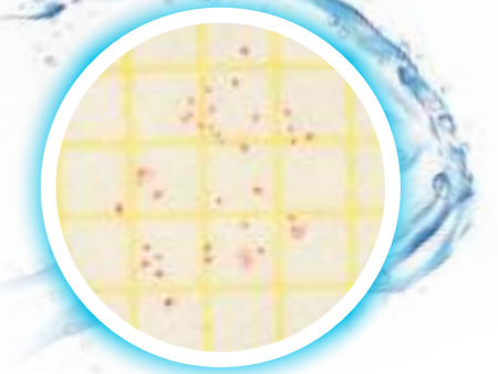
Тест-пластина Petrifilm™ Aqua для подсчета гетеротрофных микроорганизмов (AQHC) Все колонии микроорганизмов окрашены в красный цвет независимо от размера и интенсивности цвета. Результаты через 48 ч.
